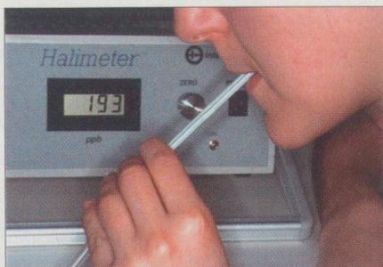
Abb. 1: Der Halimeter® dient der Konzentrationsmessung flüchtiger Schwefelverbindungen (volatile sulphur compounds = VSC)
