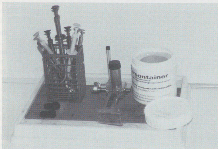
Abb. 2: Mercontainer, gut zu erkennen ist die Bindung und Umwandlung des aufgenommenen Quecksilbers
