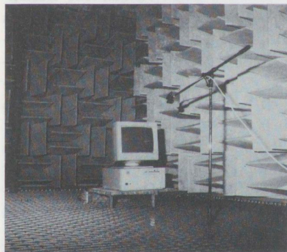
Abb 3: Geräuschmessung von Lüfter und Festplatte aus 70 cm Abstand
